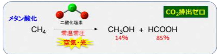
図1 二酸化塩素によるバイオガスに含まれるメタン酸化の反応式
